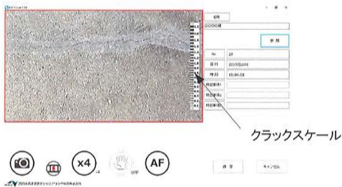
静止画像撮影時のクラックスケール表示
